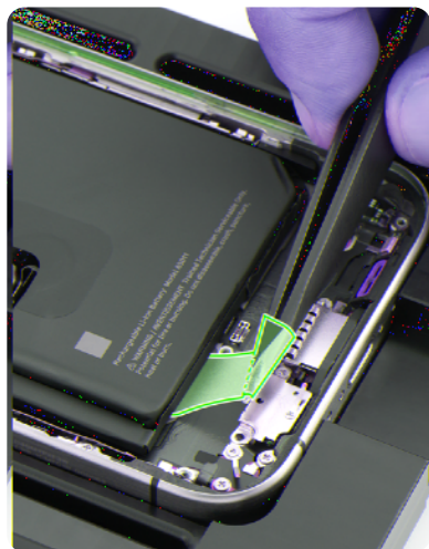
Baterie iPhone jsou zajištěny pomocí pokročilých lepidel, která jsou navržena tak, aby se uvolnila při natažení v určitém směru, což umožňuje výměnu baterie.
