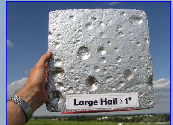
Almohadillas de espuma envueltas en papel aluminio para medir granizo
