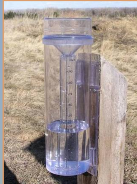
Pluviómetros de alta capacidad de 4 pulgadas de diámetro
